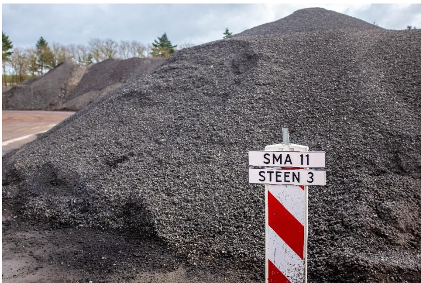
Figuur 19 Opslag van freesasfalt afkomstig van een SMA-deklaag
