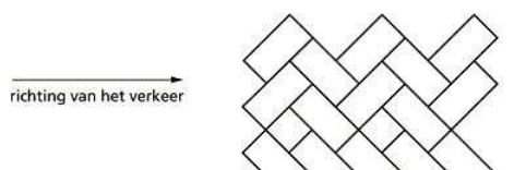
Figuur 83.3.3 Pasmaken van bestrating
